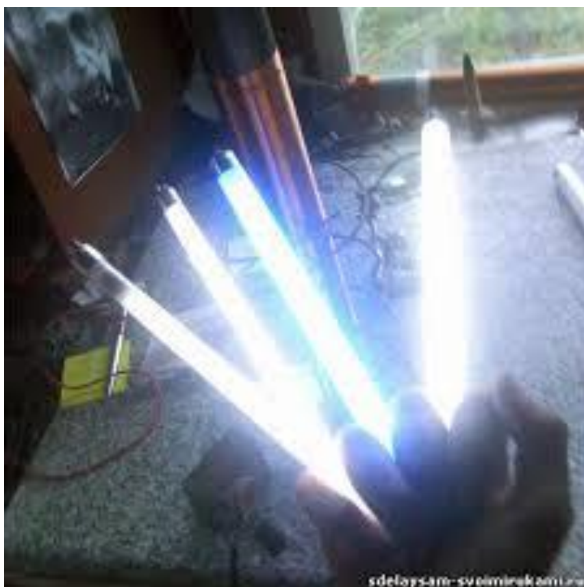
Беспроводное подключение источников света к трансформатору Тесла
